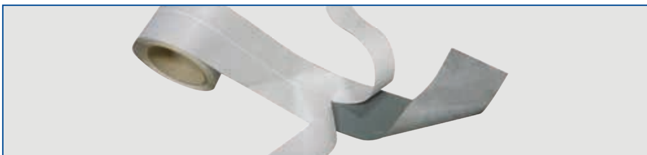
BM BAND TOTALMENTE ADESIVO - TRIPLO STRATO, DUE IN TNT PP ACCOPPIATO SU UN LATO AD UNO STRATO DI ADESIVO BUTILICO PROTETTO DA CARTA SILICONATA, DIVISA IN DUE PER FACILITARNE LA POSA
